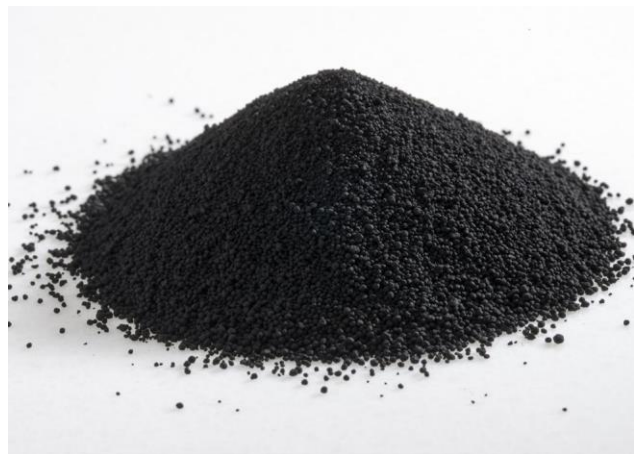
Figura 4 Pelletes de Negro de Fumo (aglomerados compactados) como é Normalmente Colocado no Mercado
